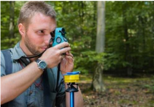
За допомогою реласкопа Біттерліха та ультразвукового далекоміра визначаються дерева для вибіркового кутового обліку.
